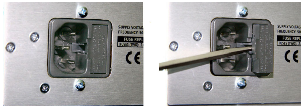
Módulo de entrada de energía Extracción de portador de fusibles
