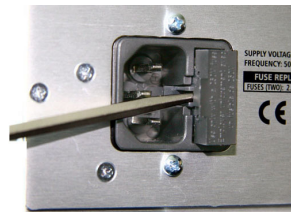
Module d'entrée d'alimentation Retrait du porte-fusibles
