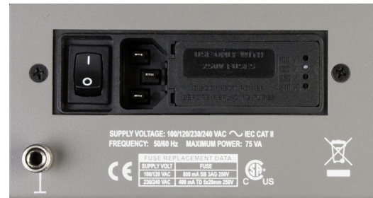
Figura 2. Detalle, módulo de entrada de energía en el panel posterior del instrumento APx. El interruptor de potencia está a la izquierda.
